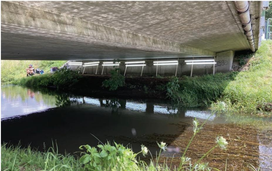
Abb. 4: Versuchsaufbau am Holzkammer Damm mit künstlicher Beleuchtung.
